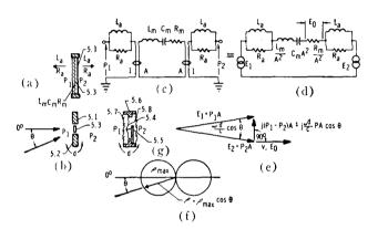
Fig. 5. Pressure-gradient microphones.
